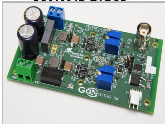
100V GaN E-HEMT フルブリッジ評価ボード, D級アンプに最適化
